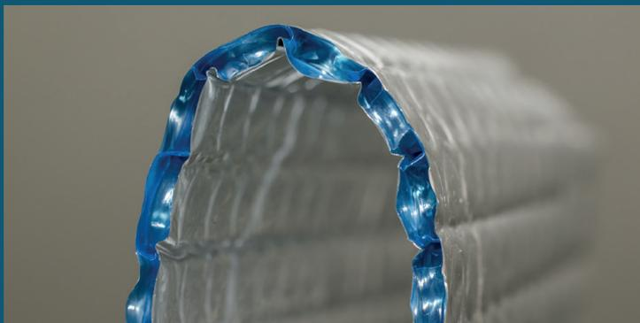
Isolamento refletivo de 3 camadas composto pela Termo fusão de duas folhas de alumínio puro que envolvem uma camada de bolhas de polietileno de baixa densidade (PEBD), tendo assim uma alta percentagem de ar em seu interior.
